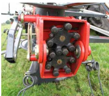
Il Fanex 1124 è dotato della versione XL della trasmissione a dita HexaLink.
