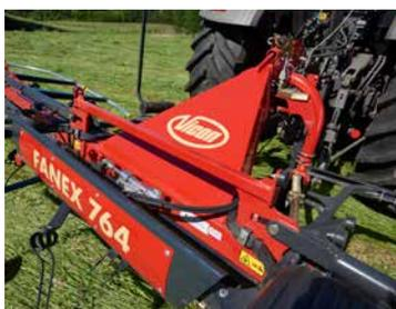
Robusto e durevole telaio con timone centrale a V.
