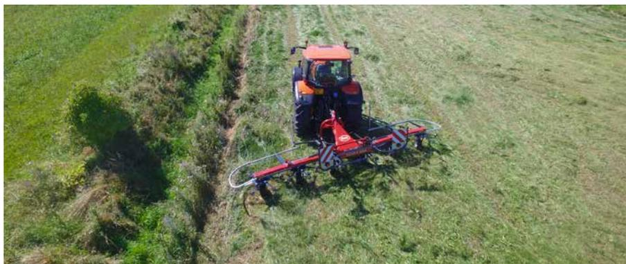
Per aumentare la produttività, questi volti sono dotati di dispositivo di spandimento in bordura meccanico. La soluzione idraulica è disponibile a richiesta. Un indicatore permette di individuare la posizione rispetto all'asse.
