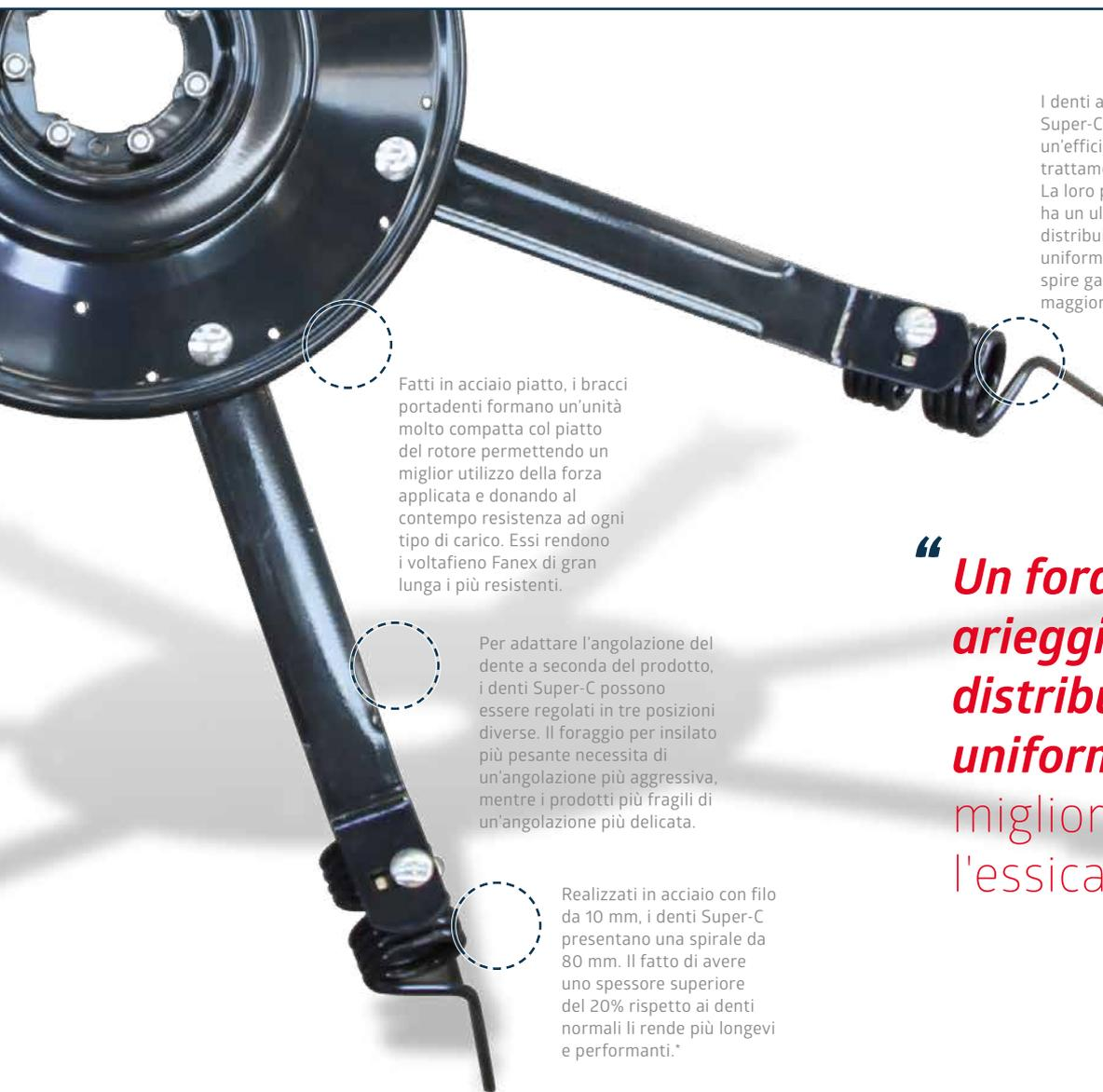
I denti a molla simmetrici Super-C assicurano un'efficiente raccolta e trattamento del prodotto. La loro particolare forma ha un ulteriore vantaggio: distribuire il carico in modo uniforme su entrambe le spire garantendo così una maggiore longevità.\*
