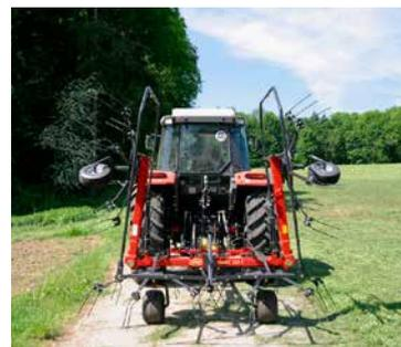
Durante il ripiegamento idraulico per il trasporto, i denti sono sollevati automaticamente.
