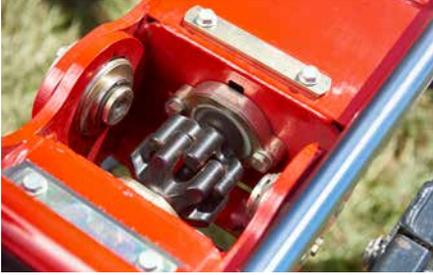
I giunti a dita HexaLink permettono un ripiegamento di 180° dei rotori per il trasporto.
