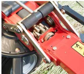
Il giunto a dita Vicon HexaLink permette un ripiegamento di 180° del rotore.
