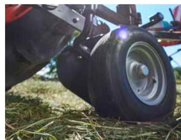
A richiesta, ruota di supporto anteriore per adattamento al terreno e azione di spandimento migliorati.
