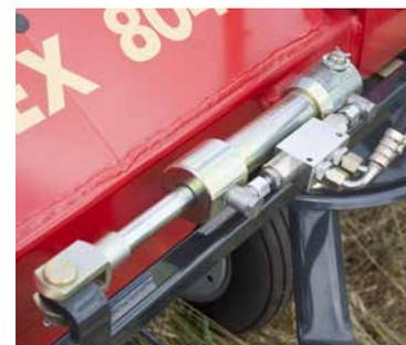
Dispositivo di spandimento in bordura idraulico (a richiesta).
