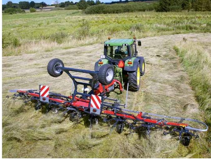
Ottieni il massimo. Con il dispositivo di spandimento in bordura il prodotto è mantenuto all'interno del campo. Il voltagieno è idraulicamente posizionato per allontanare agilmente il foraggio dal limite esterno dell'appezzamento.
