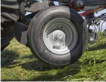
Tutti i voltaglieno possono essere dotati di una ruota anteriore che aumenta la stabilità della macchina.
