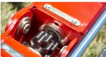
Il giunto a dita Vicon HexaLink permette un ripiegamento di 180° del rotore (Fanex 764, 904 e 1124C).
