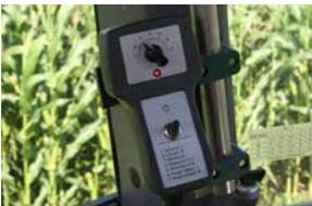
Tutte le funzioni dell'Andex 1104 sono controllate da un control-box che gestisce anche quelle idrauliche. Tutte le funzioni sono pre-selezionabili e possono essere attivate direttamente dalla cabina del trattore.
