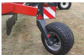
idraulicamente per il trasporto, assicurando che rimanga sempre al di sotto dei 4,00m per il trasporto. Un ulteriore vantaggio è il baricentro molto vicino al terreno che, in combinazione con l'ampia carreggiata, formata da pneumatici da 380/55-17, garantisce un'eccellente distribuzione del peso e quindi stabilità durante il trasporto.
