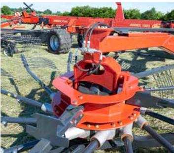
Ogni rotore può essere regolato in altezza tramite sistema idraulico.
