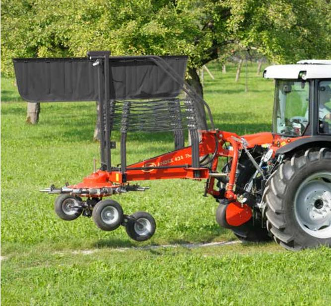
Per ridurre l'ingombro stradale basta sganciare velocemente il braccio portadenti e fissarlo al telaio tramite un supporto.
