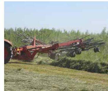
La luce da terra dei rotori in fase di sollevamento garantisce di non danneggiare le andane. Altezza regolabile infinitamente.
