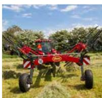
Una molla assicura l'abbassamento e il sollevamento sempre in parallelo dei rotori ed evita che i denti danneggino il terreno durante le operazioni a bordo campo.
