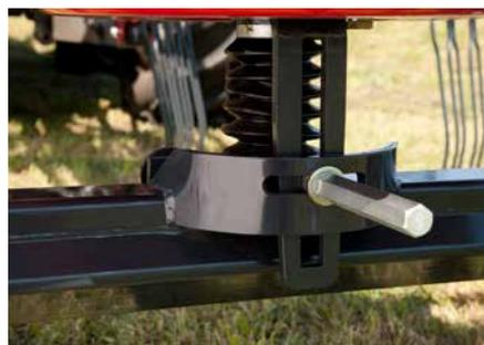
Regolazione infinitesimale delle camme, per ottenere un'ottima formazione di andana in qualsiasi condizione.
