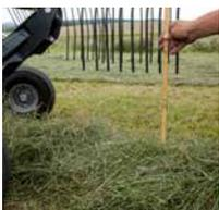
Disimpegno da terra di oltre 50cm, per oltrepassare facilmente qualsiasi tipo di andana, avviene tramite un solo distributore a semplice effetto.
