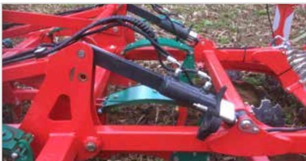
Il rullo posteriore dell'Enduro, non avendo il parallelogramma, è gestibile idraulicamente tramite distanziali.
