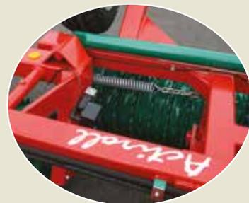
Due molle collocate su ogni estensione trasferiscono il carico equamente sulle ali (nelle versioni Actiroll da 6,30 a 8,30 m). Nei modelli Actiroll HD/HDC (da 9,50 a 16,30 m) il peso viene distribuito tramite due cilindri idraulici e un accumulatore.
