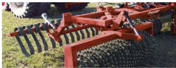
Provvisto di barra Cload Board, il rullo Actiroll HDC è un ottimo attrezzo per la preparazione del letto di semina in un unico passaggio. Ogni singola sezione è montata su un punto pivotante per garantire movimenti sicuri e seguire perfettamente il campo.
