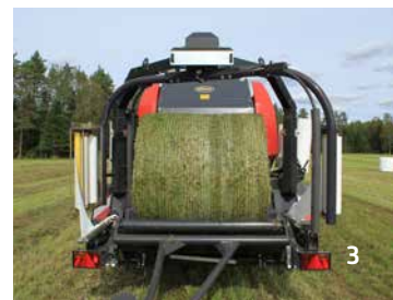
Appena la piattaforma si allontana dalla camera, il portellone si chiude automaticamente e la formazione di un'altra balla può iniziare.
