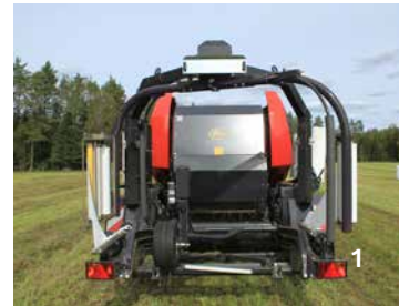
Una volta iniziato il processo di legatura la piattaforma del fasciatore si avvicina al portellone.
