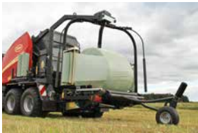
Fasciatore con 2 satelliti di pre-stiramento e piattaforma a 4 cinghie senza fine per una fasciatura rapida e stabile.
