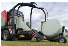
Ribaltatore balla. La balla è automaticamente ruotata sul lato piatto allo scarico dal fasciatore.
