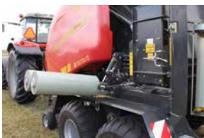
Porta rotoli di film azionati idraulicamente per la massima praticità dell'operatore.
