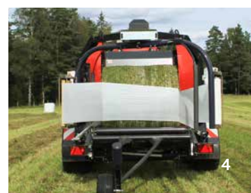
La piattaforma è mossa rapidamente in posizione e la fasciatura inizia immediatamente.
