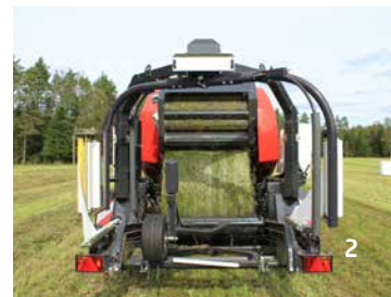
La balla è scaricata direttamente sulla piattaforma del fasciatore.
