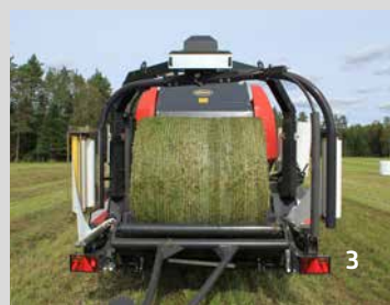
Appena la piattaforma si allontana dalla camera, il portellone si richiude automaticamente e parte la formazione di un'altra palla.
