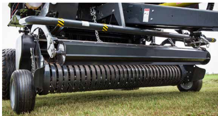
Il deflettore, con rullo di grande diametro, per velocità di avanzamento maggiore.
