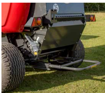
L'allontanatore della palla (a richiesta) assicura un'espulsione senza il bisogno di fastidiose manovre di retromarcia.
