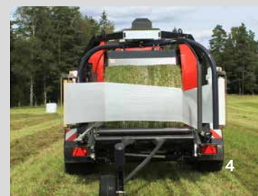
La piattaforma del fasciatore si muove rapidamente in posizione di lavoro e la fasciatura ricomincia.
