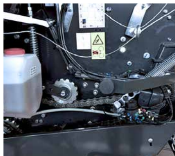
Lubrificazione delle catene automatica, con dosatore regolabile individualmente.
