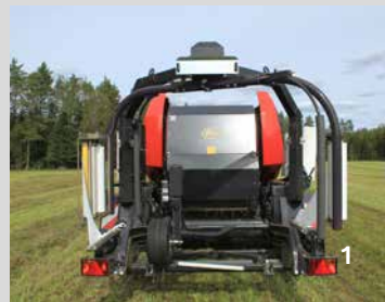
Una volta legata la palla viene trasferita verso il fasciatore che nel frattempo si avvicina allo scarico.
