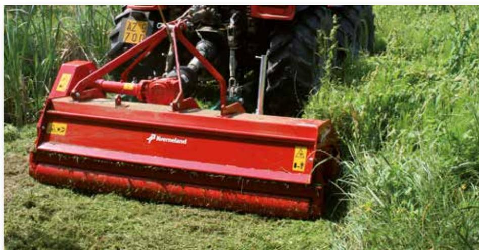
Il plus di questi modelli è il rotore, che sull'FM offre un'elevata velocità di rotazione (1993 giri/min). Inoltre è disponibile un sistema di contro-bilanciamento meccanico, in quanto la testata d'attacco può essere montata in posizione intermedia oppure laterale, in base alle esigenze del momento.
