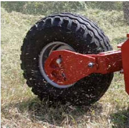
Ruote semi-pivotanti (Modello 10/8.0 x 12.8 tele) che assicurano una grande stabilità e una profondità di lavoro costante.
