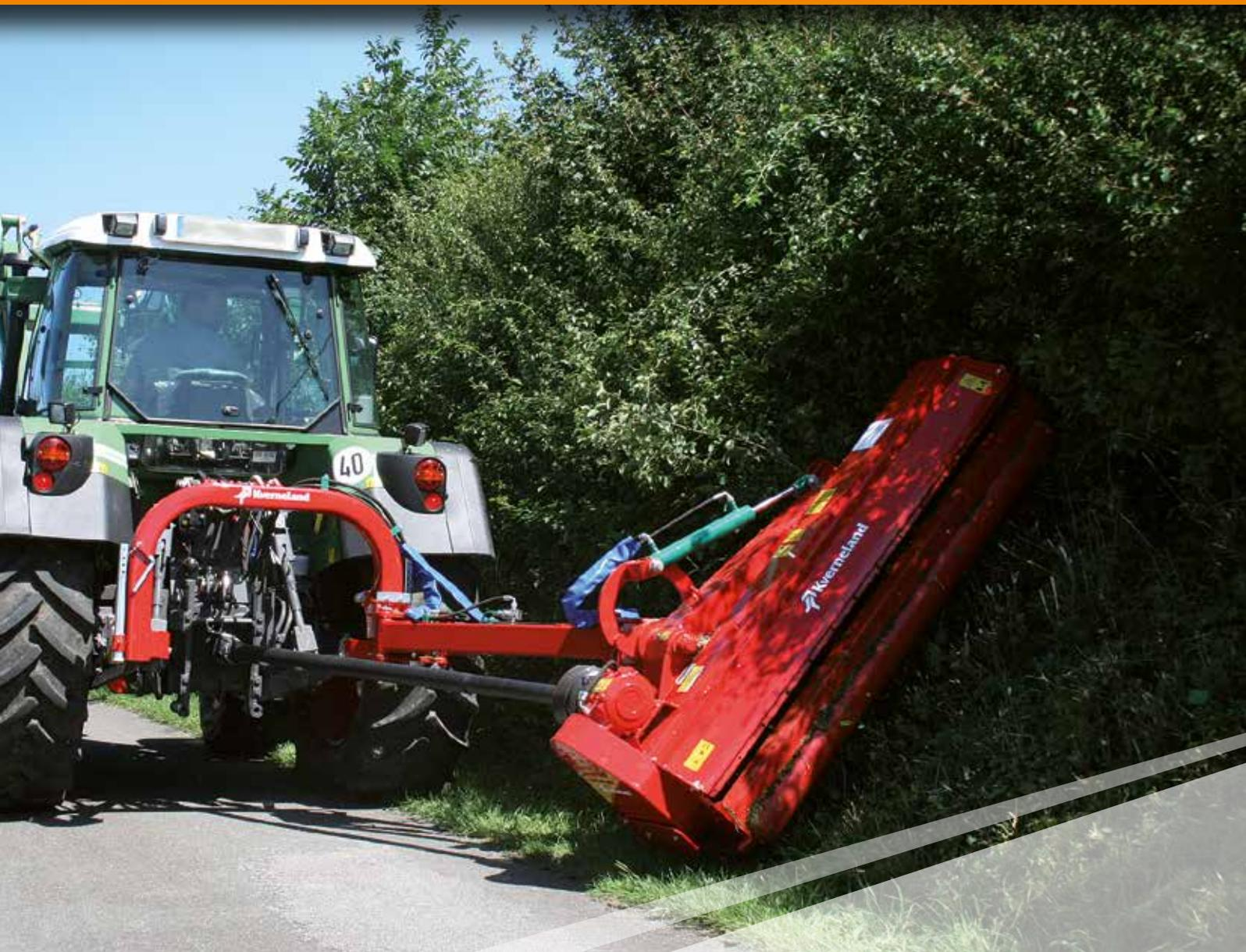
Il trincia erba Kverneland FHP è un modello multiuso, in grado di lavorare efficientemente a fine campo o in prossimità di fossi e siepi. Inoltre è una macchina adatta alla trinciatura di erba, legno leggero e siepi ed è quindi ideale per la manutenzione di parchi, giardini e aree verdi sui cigli delle strade.
