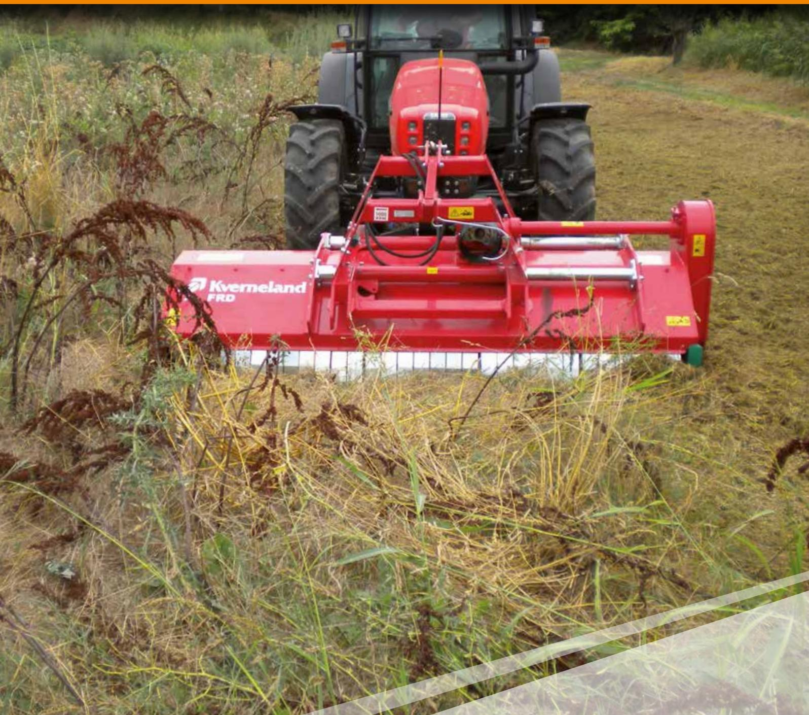
La doppia testata di attacco, la stessa che viene utilizzata sugli erpici rotanti Kverneland, consente di montare l'FRD sia frontalmente che posteriormente. Anche su questo modello è presente il sistema di spostamento idraulico di 52 cm.
