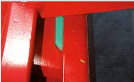
Speciale piastra in nylon che assicura semplici movimenti senza necessità di lubrificazione o manutenzione.
