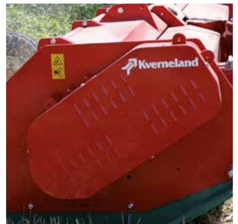
L'FXZ è provvisto di una doppia trasmissione laterale. I punti di ingrassaggio esterni e centralizzati sul rotore sono garanzia di una manutenzione meno frequente e più rapida.
