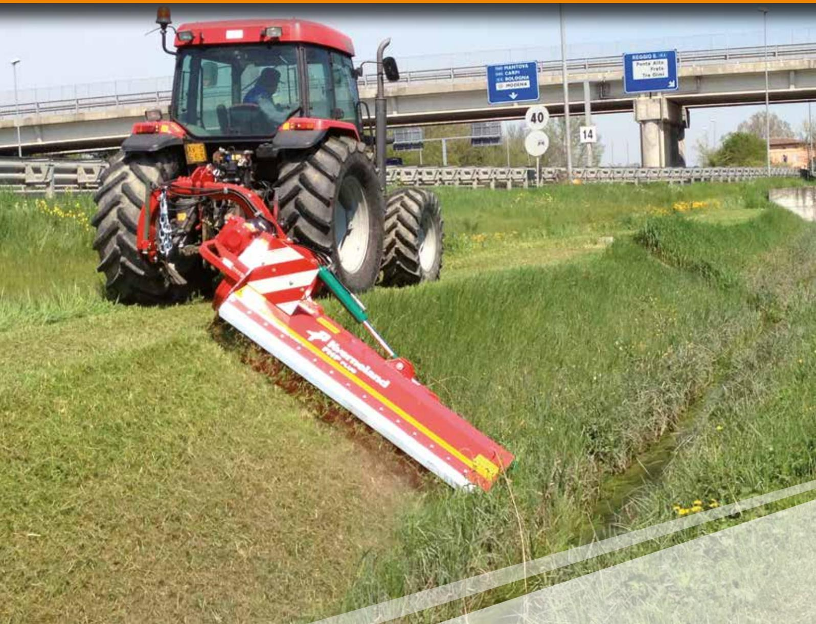
Un modello estremamente versatile sia per il lavoro agricolo che per la manutenzione stradale. Grazie alla possibilità di regolare diverse posizioni dell'angolazione di lavoro, l'FHPplus diventa indispensabile per il lavoro di tutti i giorni. Compatto e robusto, facilmente manovrabile e affidabile. Nella versione plus offriamo uno spostamento laterale di 1255 mm ed un ottimo bilanciamento. Inoltre l'FHP plus può essere combinato ad un trincia frontale (FRO o FRD), così da ottimizzare il lavoro.
