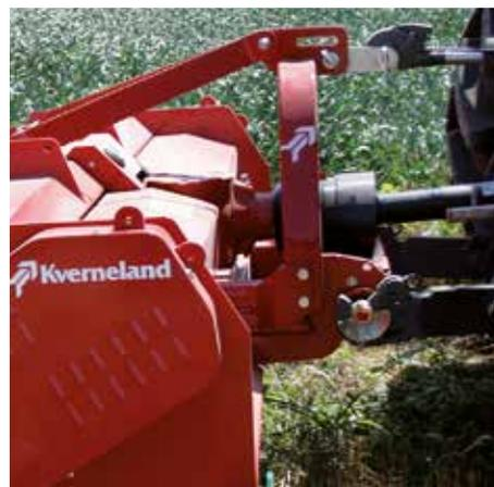
Attacco semi-automatico di Cat. III per un attacco veloce al trattore. Il supporto snodato sul 3° punto permette di controllare in tutta semplicità la profondità di lavoro senza sollecitare la testata d'attacco.
