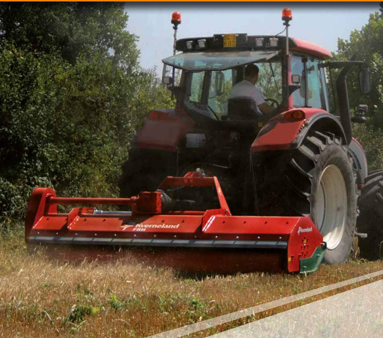
Il trincia erba Kverneland FRH è un modello versatile, adatto al taglio di erba e stoppie in pascoli e maggesi. Grazie al suo sistema di spostamento idraulico, il trincia erba FRH consente di ripulire anche il terreno a fine campo, frutteti e cigli della strada, ed è quindi la soluzione ideale per la manutenzione sia dei vostri campi che della vostra azienda agricola. I coltelli a mazza o, in alternativa, i coltelli
