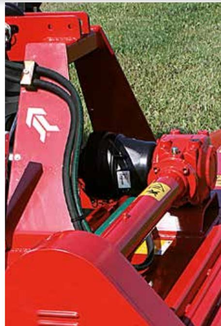
Scatola di trasmissione fino a 80 hp - velocità di trasmissione della PTO di 540 giri/min. Protetta da ruota libera integrata.
